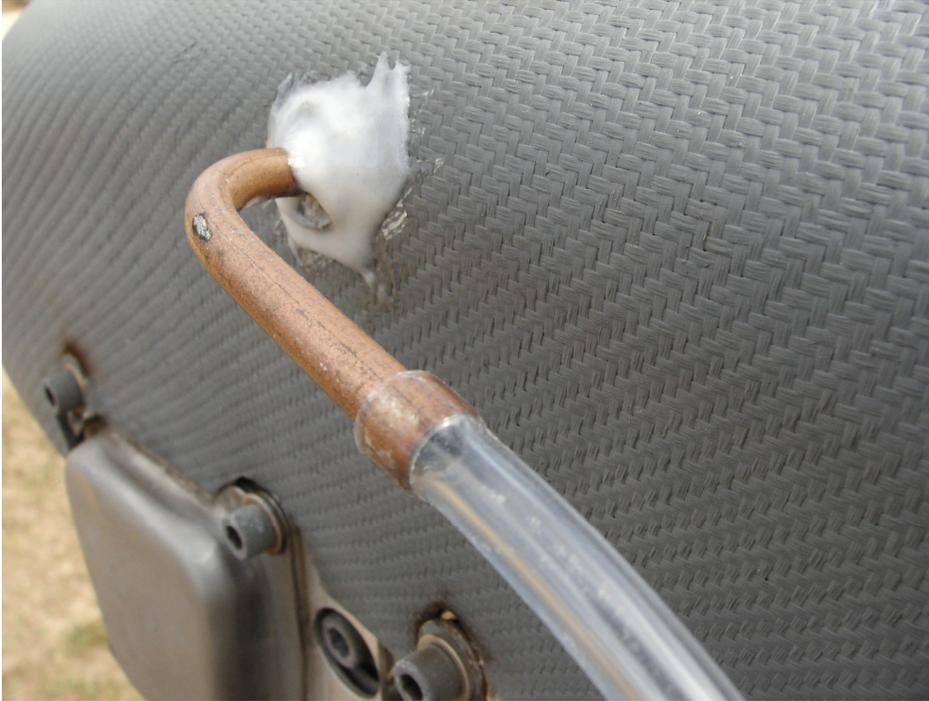
**Figure 2: Prise de pression d'air directe ( ram air).**
