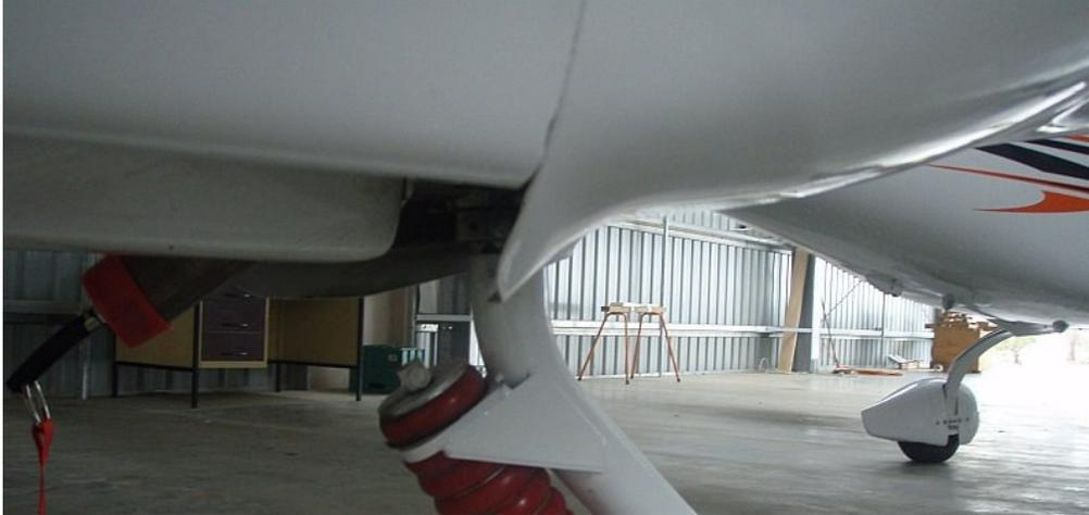
**Figure 4: Lèvre aidant au refroidissement installée sur un Jabiru.**
