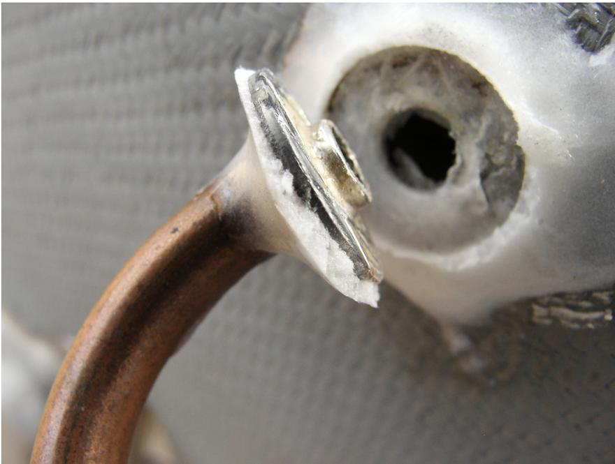
**Figure 3: Prise de pression montrant l'affleurement sur l'intérieur de l'écope.**
